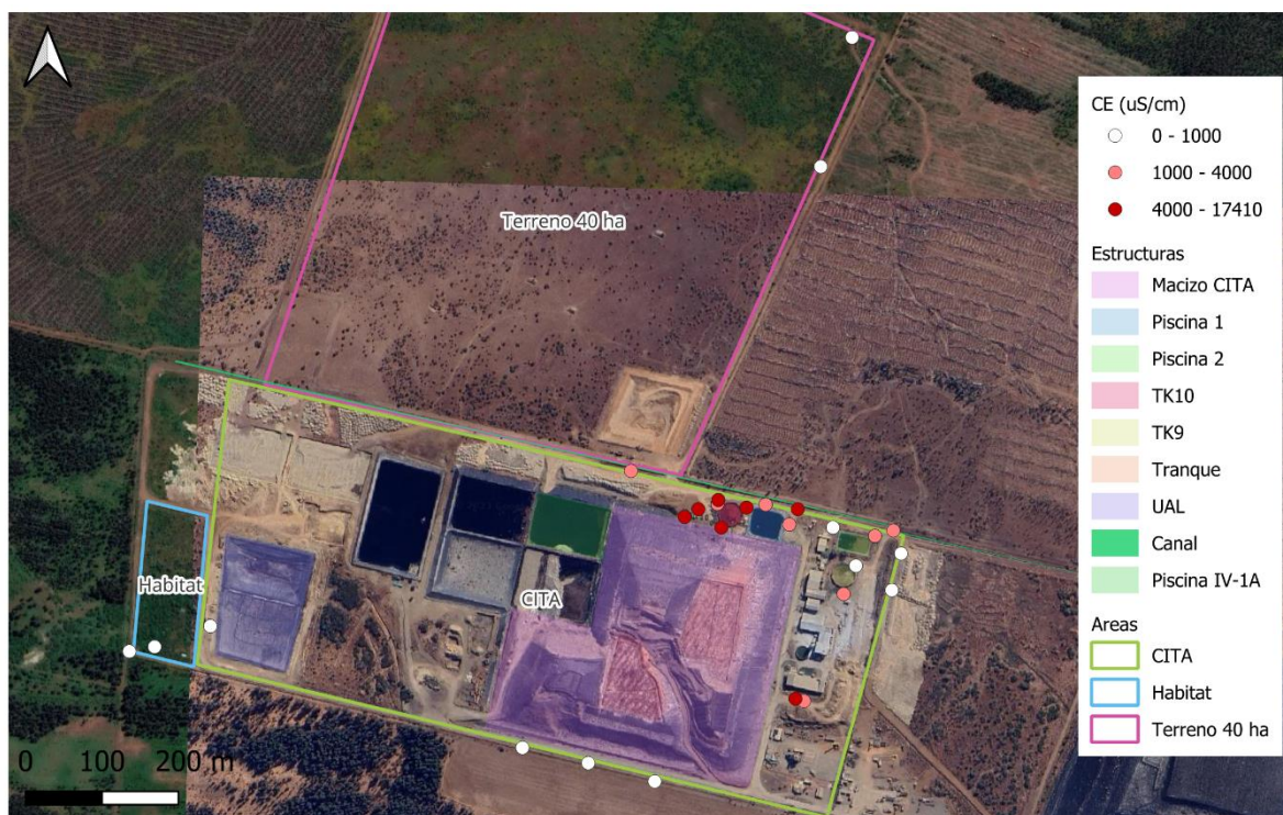
Figura 7-1 – Resultados de conductividad eléctrica en suelos
